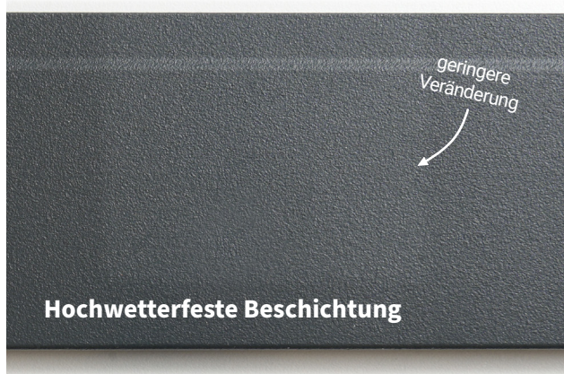
Farbtonveränderung nach 700 h QUV-B, DIN EN ISO 16474
